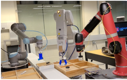
Fig. 3: Robot Raconteur Box Packing Example [17]
